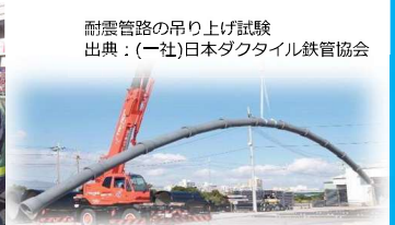
地震の揺れでも抜け出さない耐震管
