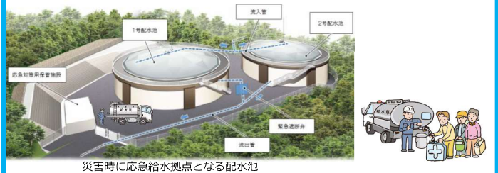
災害時に応急給水拠点となる配水池
