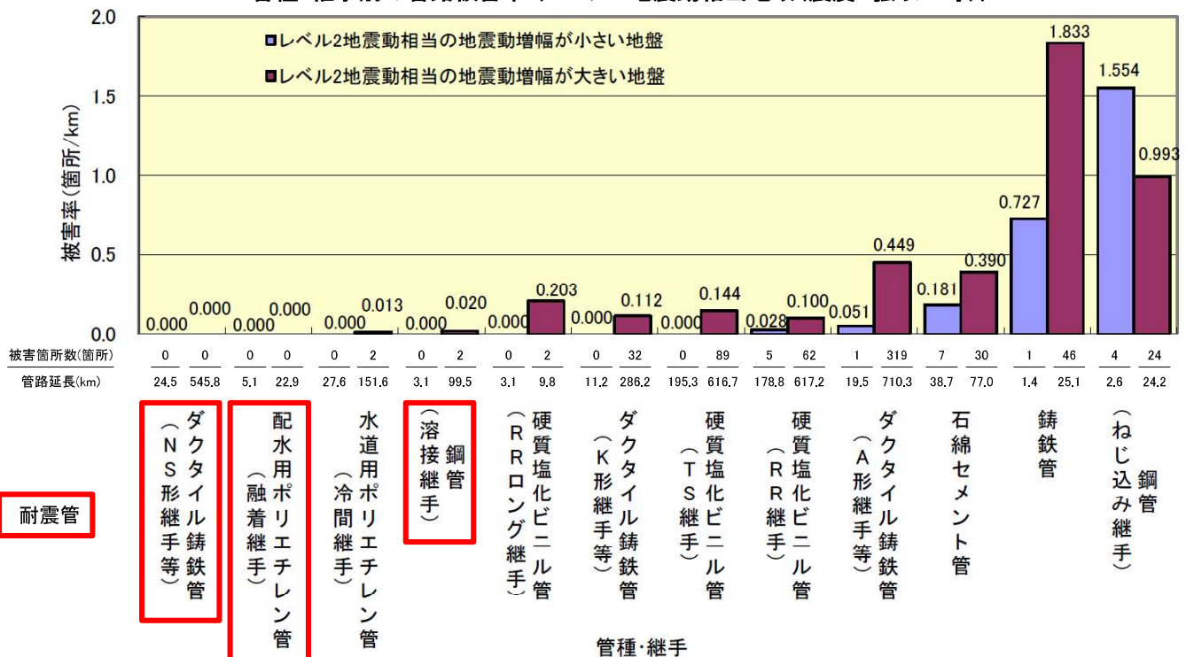
管種・継手別の管路被害率(レベル2地震動相当地域(震度6強以上等))
