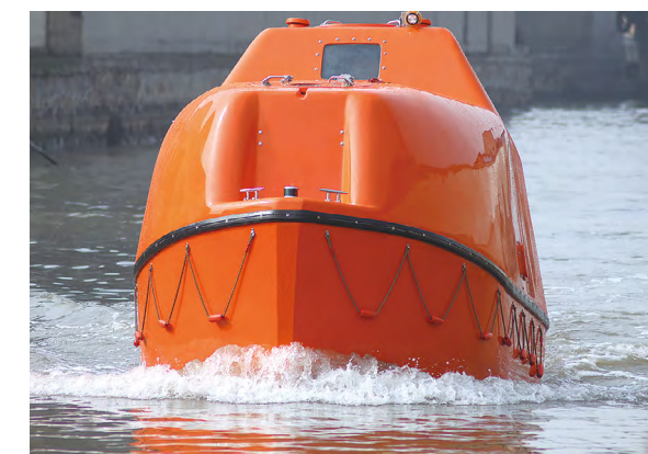
津波救命艇シェルター「+CAL (タスカル) 25」。SOLAS (国際海上人命安全条約) 基準にもとづく基本設計を採用する
